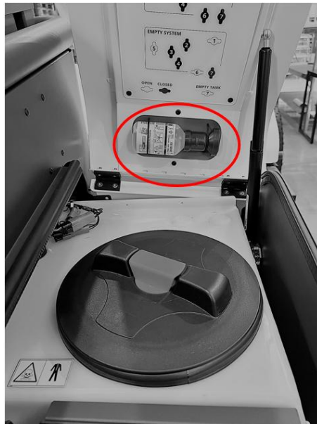
Abbildung 5 - Die Augendusche befindet sich unter der linken Klappe
