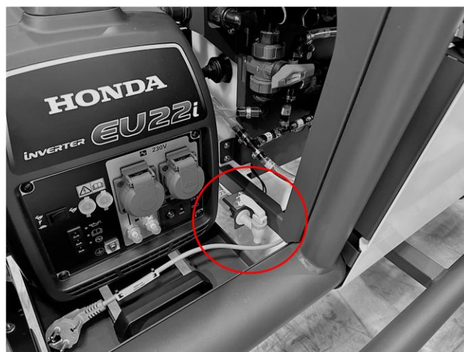
Abbildung 6 - Der Wasserhahn befindet sich zwischen Generator und Tank
