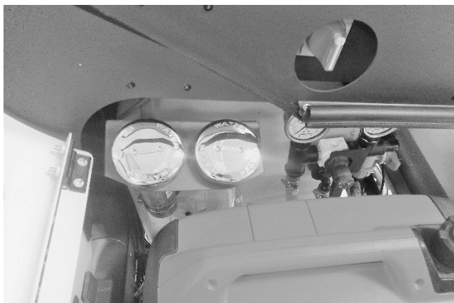
Figur 22 – Rentvannstank og skyllevannstank
